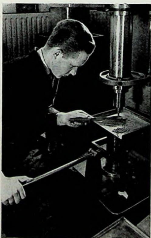
Het persen van pastilles van keramisch weerstandsmateriaal (voor N.T.C.-weerstand).
