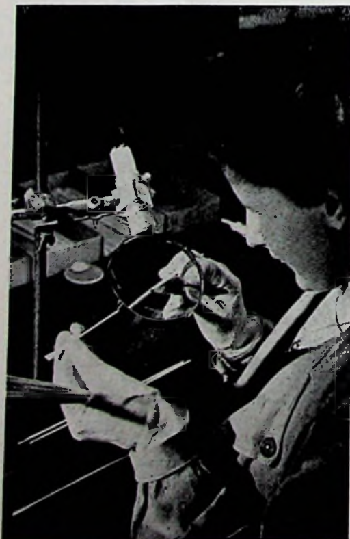
Keramische condensatormaterialen worden nauwgezet op foutjes onderzocht.
